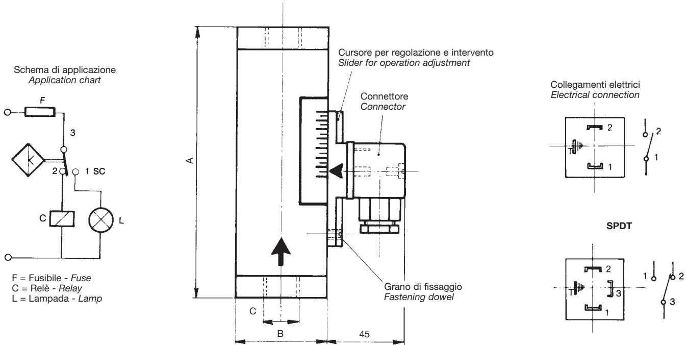
N.B. - Negli ordini indicare: tipo di fluido da controllare, viscosità del fluido, temperatura di lavoro, pressione d'esercizio.
